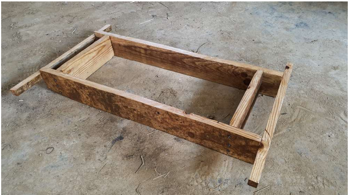
Figura 4. Molde de madera para la producción de paneles de tierra
