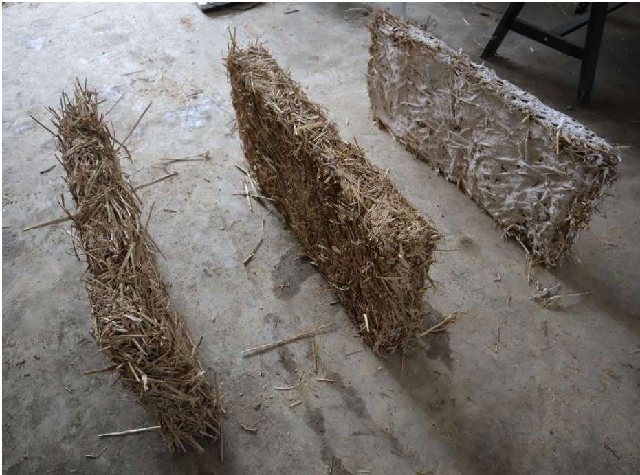
Figura 2. Distintas pruebas de los paneles elegidos para la producción y colocación en obra. De la izquierda para la derecha: panel 1, 2 y 3
