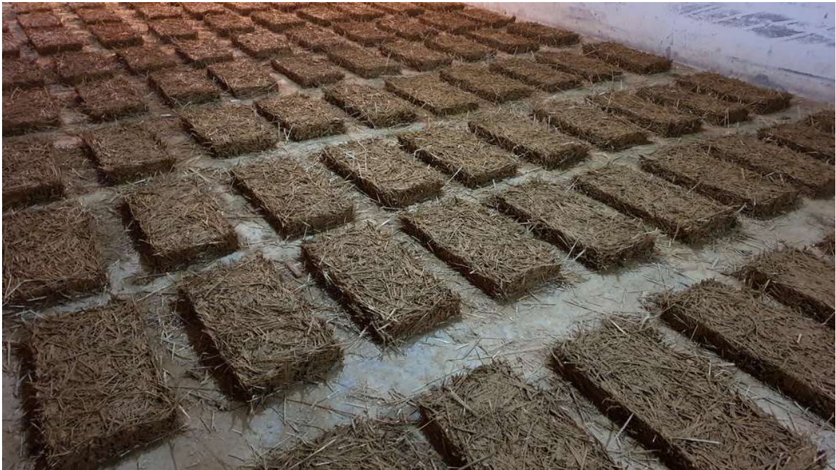
Figura 6. Paneles aislantes de tierra en proceso de secado
